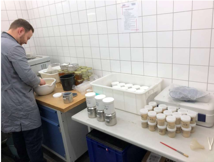
Abbildung 8: Aufbereiten der Bodenproben mithilfe eines Mörsers und einer Kugelmühle
