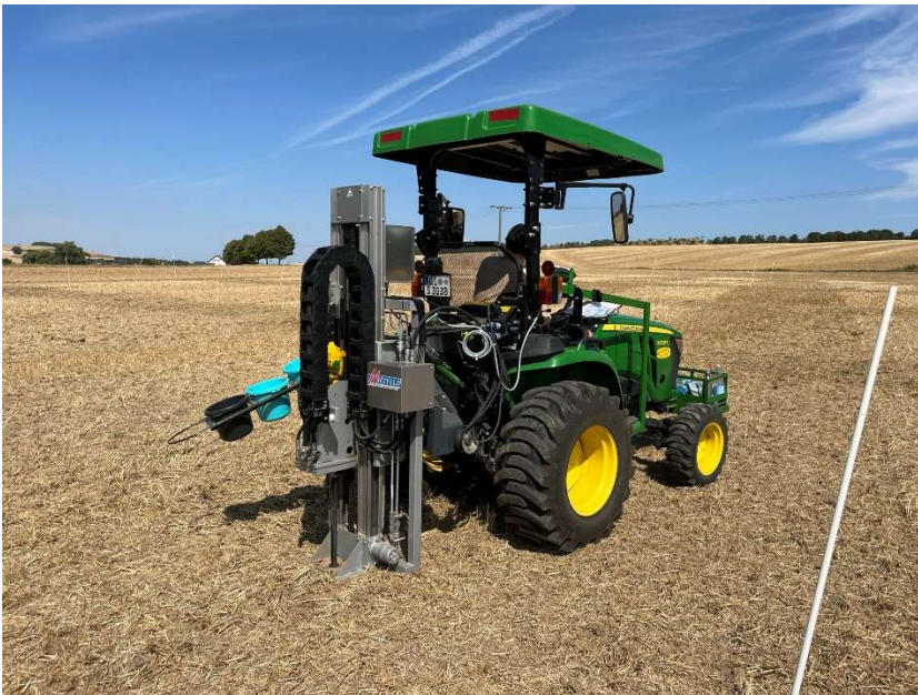
Abbildung 24: Entnahme der Bodenproben mithilfe eines Traktors und einem Entnahmegerät
